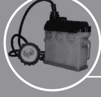
Современный шахтерский светильник "Коногонка"
