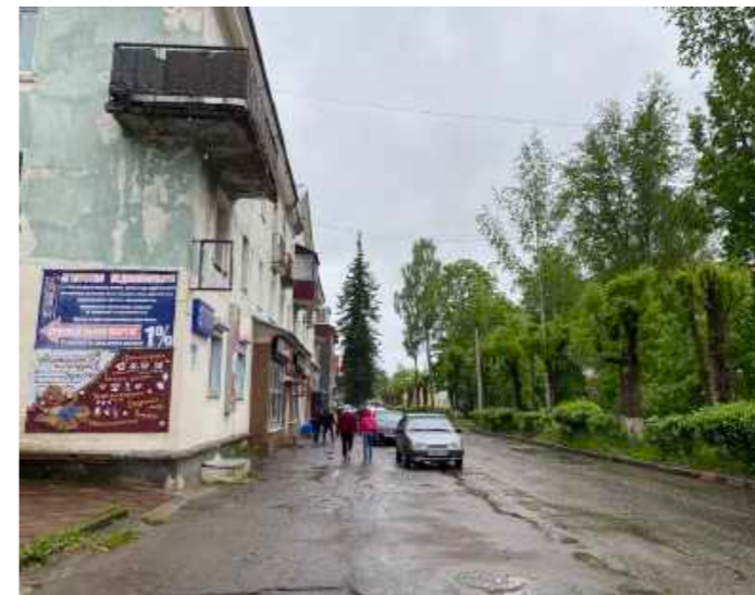
5. Улица Горького. Улица однополосная с односторонним движением. Вдоль дороги неорганизованные парковочные места. Практически отсутствует граница между пешеходным тротуаром и полосой движения транспорта. Много взрослых деревьев по обеим сторонам улицы.
